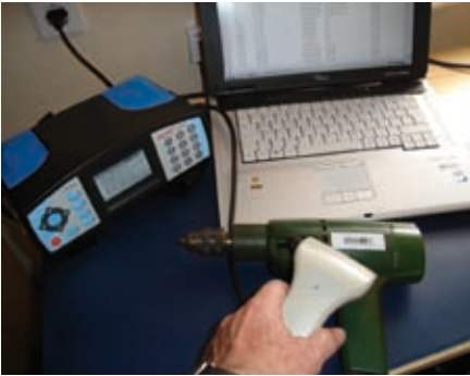
Bild 3: Rechnergestützter Prüfplatz mit Barcode-Scanner
